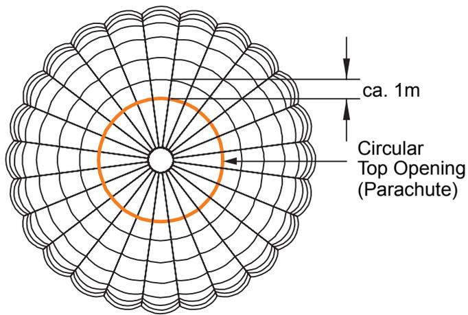
Der Temperatursender sollte ungefähr 1 Meter unterhalb des Top's montiert werden
